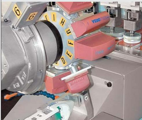
Costituita da un tamburo capace di ospitare fino a 12 tamponi disposti radialmente, per stampare su superfici differenti di un oggetto, anche diversamente angolate fra di loro. Inoltre l'oggetto può essere movimentato su ulteriori assi a controllo, al fine di essere decorato completamente in un unico ciclo di stampa. In questa versione l'interasse tra i cliché non influisce sulla dimensione dell'oggetto da stampare.
